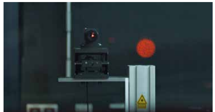
Testovacia inštalácia v optickom laboratóriu: Laserové svetlo na meranie zdvojeného obrazu.
